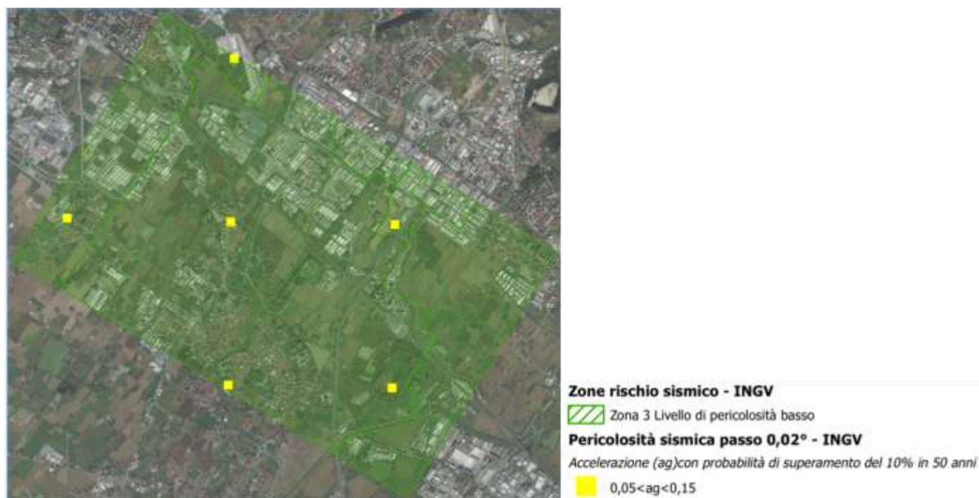
Figura 5-16 Pericolosità e rischio sismico – quadrante nord-ovest (Fonte: INGV)
