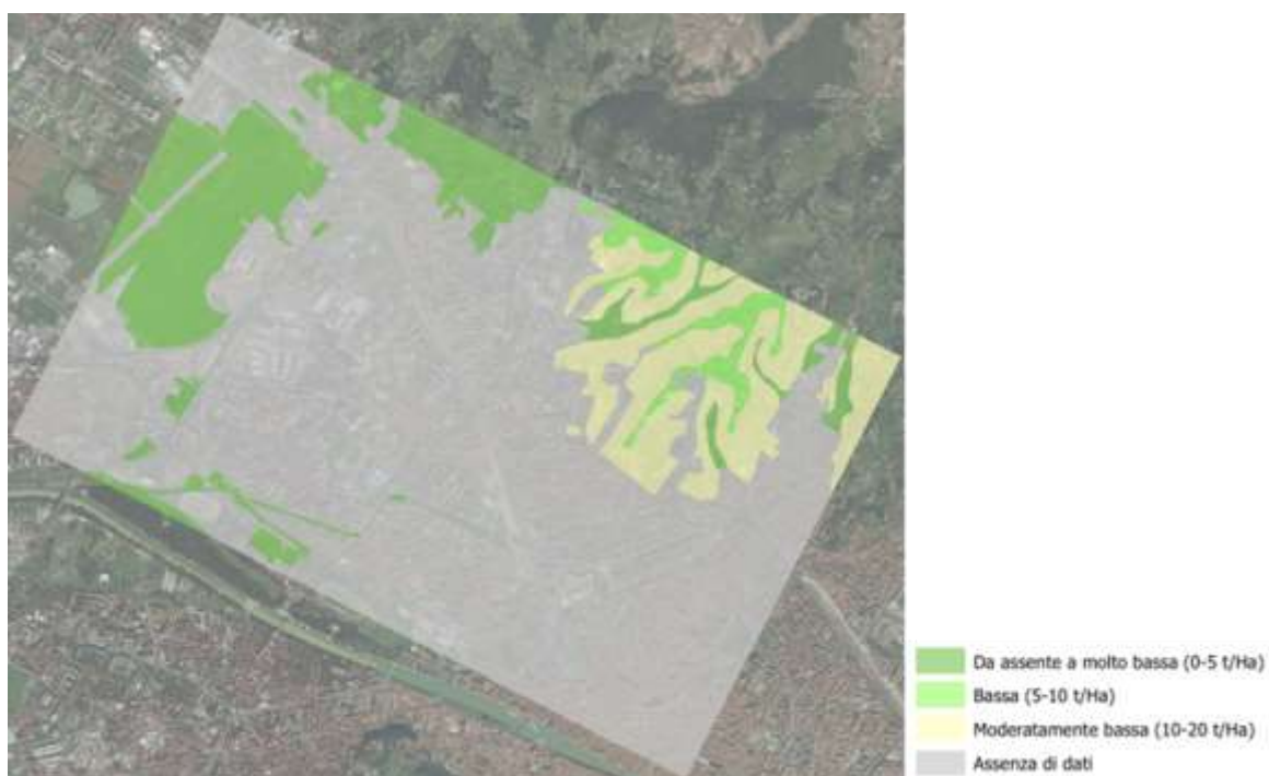
Figura 6-9 Erosione potenziale (Fonte: Regione Toscana)
