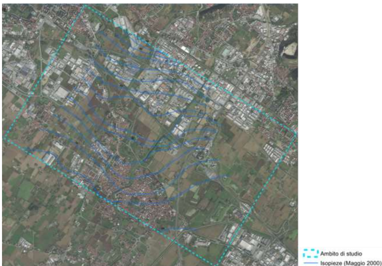
Figura 5-18 Carta delle isopieze – quadrante nord-ovest (Fonte: Piano strutturale del Comune di Campi Bisenzio)
