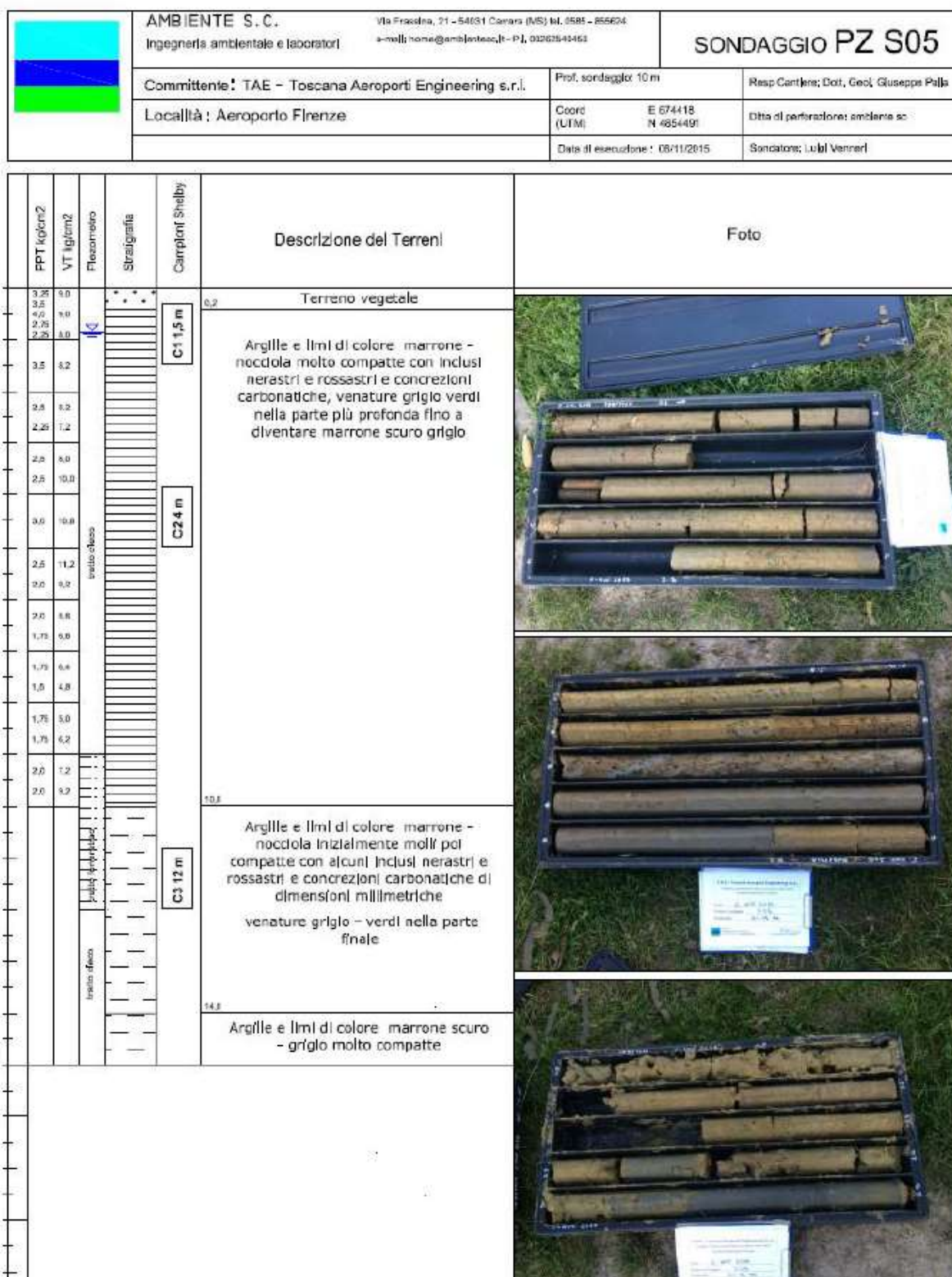
Figura 26 - Stratigrafia del sondaggio S05 realizzato durante la campagna geognostica presso l'area di progetto (in arancione in Figura 22)
